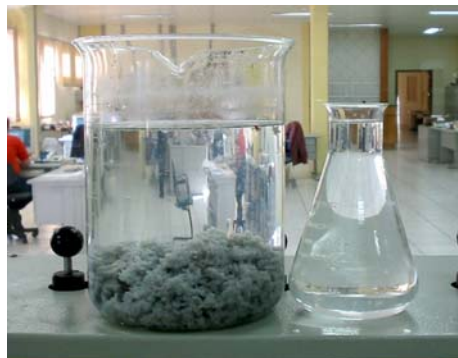
Figura 37 – Fotografia mostrando efluente tratado físico-quimicamente por coagulação-floculação
