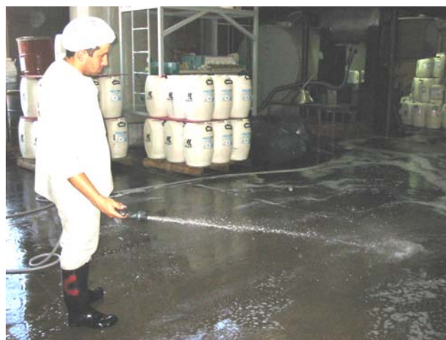
Figura 20 – Fotografia da operação geradora das águas de lavagens dos pisos
