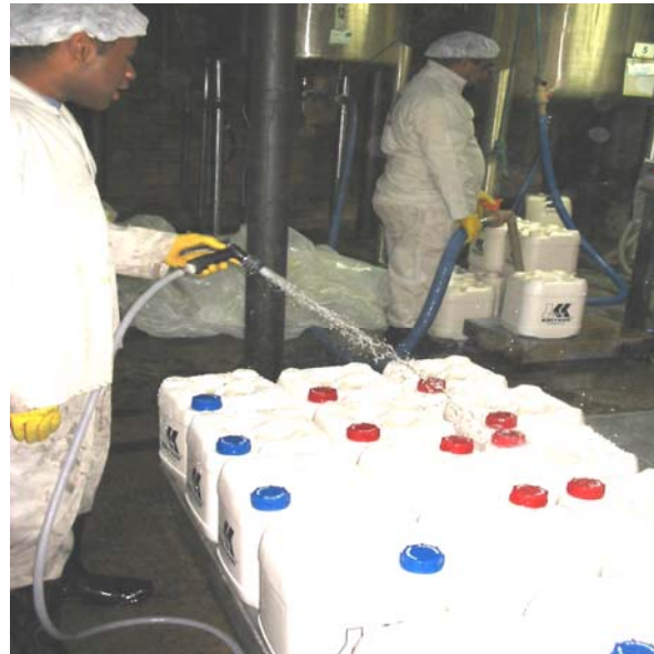
Figura 18 – Fotografia da operação geradora das águas de lavagens dos pallets com embalagens cheias.
