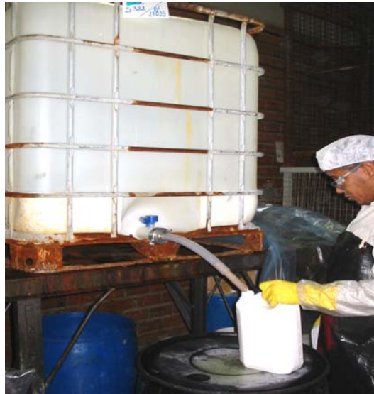
Figura 22 – Fotografia dos derramamentos provenientes do envase que se destinam ao piso
