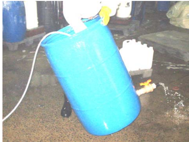
Figura 19 – Fotografia da operação geradora das águas de lavagens das bombonas de produção
