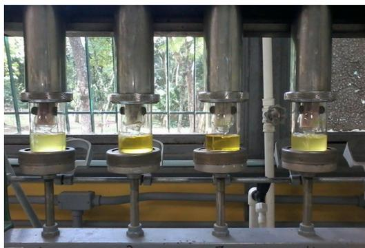
Figura 1. Extração de extrato etéreo em aparelho Goldfish
