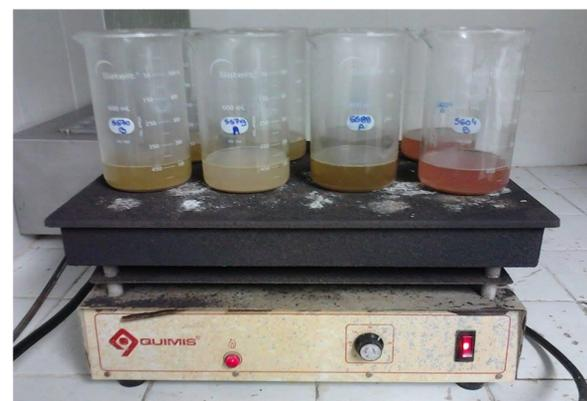
Figura 2. Digestão com HCL em chapa aquecida à 100°C na técnica de hidrólise ácida.
