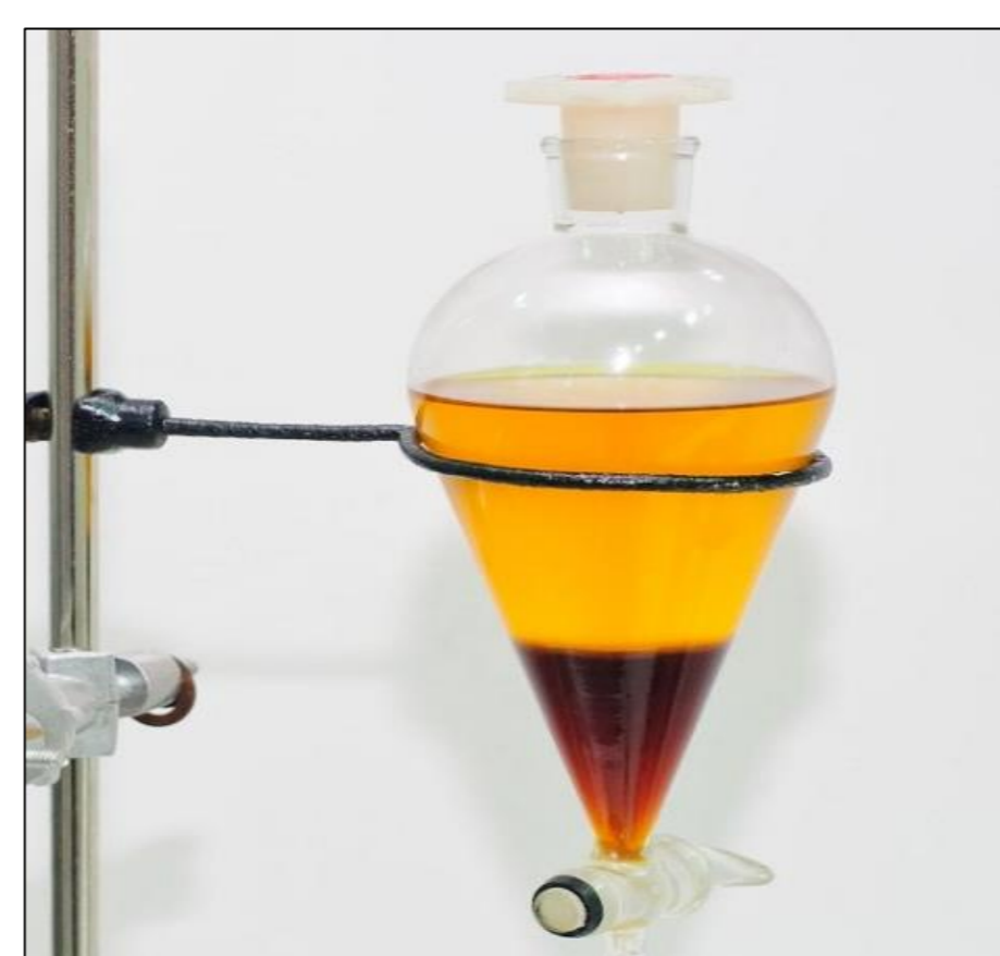
Figura 3 – Glicerina e biodiesel em duas fases imiscíveis.
