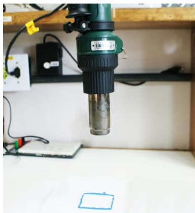
Figura 19. Soprador de ar fixado para teste de tempo de expansão da tinta.
