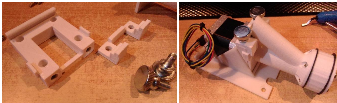
Figura 38: (a) Sistema de encaixe do motor com o suporte do estator; (b) Novo sistema montado.
