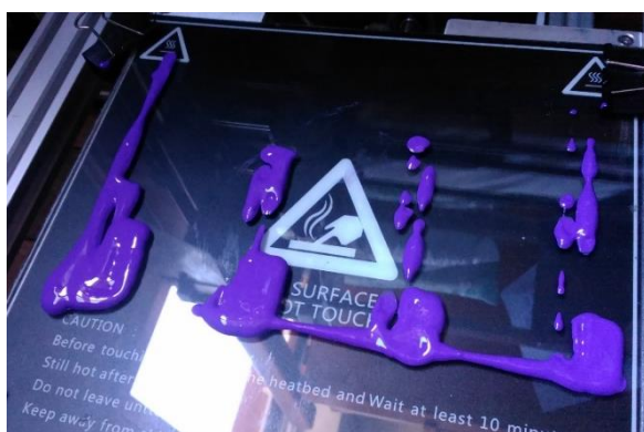
Figura 39: Resultado da impressão utilizando a bomba helicoidal 2 com rotor e estator de 1 estágio. 13
