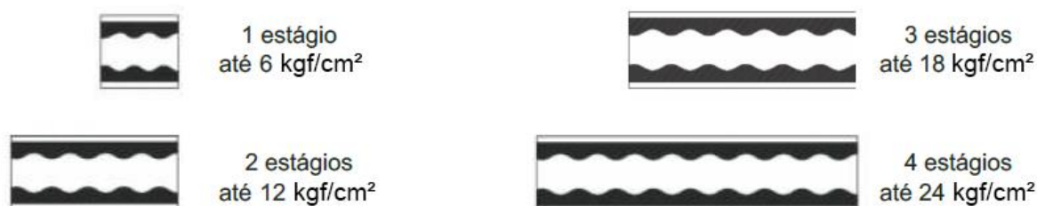
Figura 30: Relação quantidade de estágios e pressão na bomba helicoidal.
