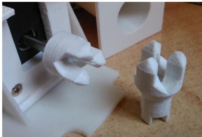
Figura 37: Novo eixo móvel e seu encaixe de acoplamento ao eixo do motor.
