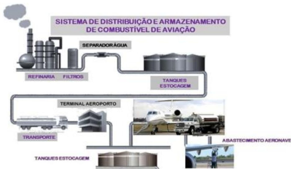
Figura 2 – Visualização do sistema de armazenamento e distribuição de combustíveis de aviação, da refinaria ao tanque da aeronave. Fonte: Adaptada de Wipro, 2022.
