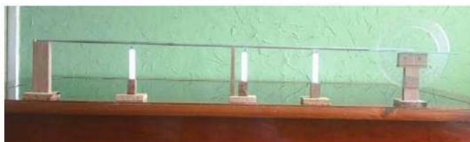
Figura 04: Experimento dilatação térmica de sólidos
