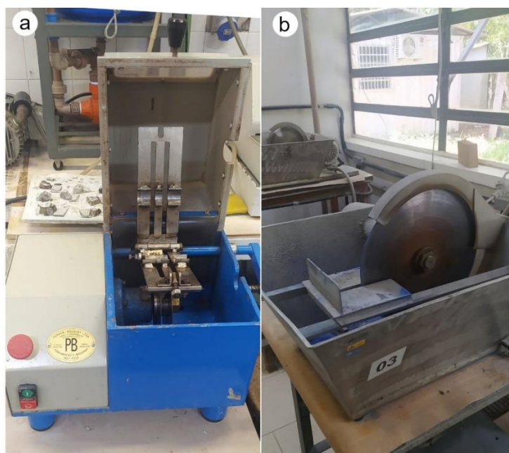
Figura 11: Serras utilizadas na preparação das amostras, sendo (a) serra de disco duplo Person Bouquet e (b) serra de corte.
