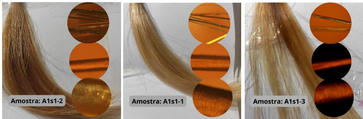
Figura 31: Foto das amostras *A1S1-1*, *A1S1-2*, *A1S1-3* acompanhada das micrografias obtidas com microscópio de luz polarizada com ampliação de 100, 200 e 1000mm utilizando lente polarizadas.
