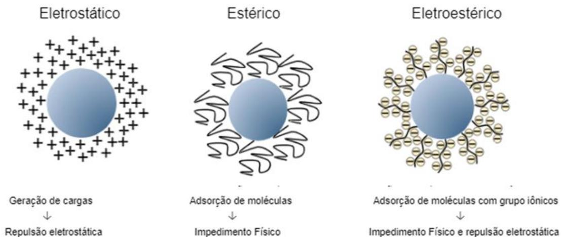
Figura 2. 22 – Mecanismos de dispersão de nanopartículas em um líquido
