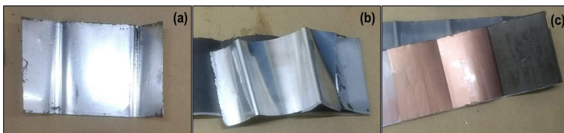
Figura 4.3. Carcaça (a), lâmina suporte do cátodo (b) e lâmina suporte do ânodo (c) de uma BIL após ser manualmente desmontada, como exemplo a bateria da Samsung.
