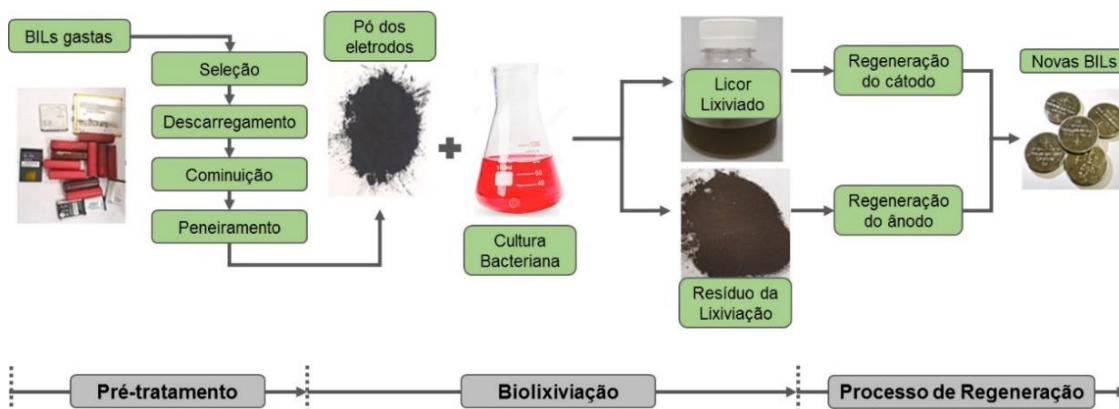
Figura 3.17. Fluxograma do processo de biolixiviação de BIL. Fonte: Adaptado de Roy et al. (2021).
