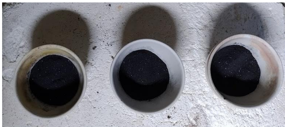
Figura 4.7. Cadinhos de porcelana contendo amostras F1 para serem tratadas termicamente à 650 °C.
