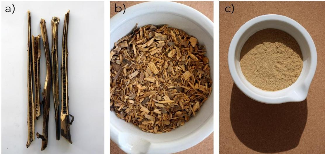
Legenda: a) caules secos após secagem em forno caseiro naturalmente ventilado com lâmpada incandescente; b) aspecto físico do material natural após ser processado no granulador Dynisco; c) aspecto físico final do RCTP.
