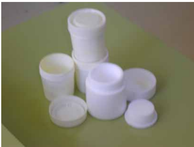
Figura 9 – Reatores plásticos para testes hidrotérmicos em temperaturas de até 100°C.
