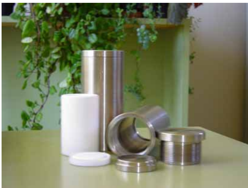
Figura 10 – Reatores metálicos com interno de Teflon para testes hidrotérmicos em temperaturas maiores que 100°C.
