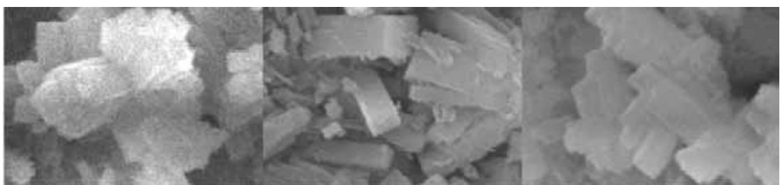
Figura 14 – Cristais típicos de EDI obtidos por hidrotratamento de cinza P.
