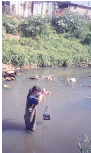
Figura 3: a) Amostrador do tipo draga de Eckman, sendo utilizado na estação amostral 3, no Arroio Sapucaia, RS; b) Esquema de um Amostrador do Tipo Draga de Eckman (esquema cedido pelo Dr. Nelson Machado, Laboratório de Sedimentologia – Centro de Ecologia – UFRGS).
