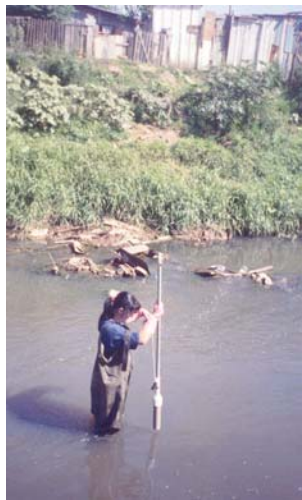
Figura 2: a) Amostrador do tipo “corer hand”, sendo utilizado na estação amostral 3, no Arroio Sapucaia, RS; b) Amostrador elaborado para estudos neste arroio.
