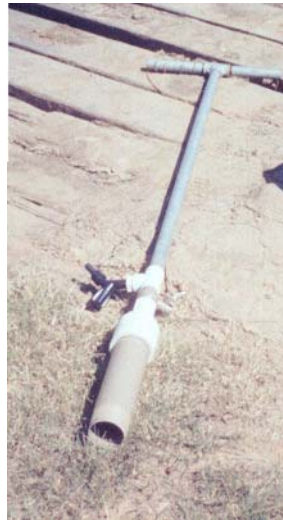
Figura 2: a) Amostrador do tipo “corer hand”, sendo utilizado na estação amostral 3, no Arroio Sapucaia, RS; b) Amostrador elaborado para estudos neste arroio.
